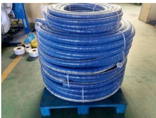
Пищевой напорно-всасывающий рукав, изготовленный для подачи под напором и всасывания жидких и густых пищевых продуктов: пиво, вино, крепкий алкоголь 70 %, б/а напитки, соки и молочные продукты. **Рукав не рекомендуется устанавливать на перекачку жиросодержащих пищевых продуктов с содержанием жира выше 30 %.**
